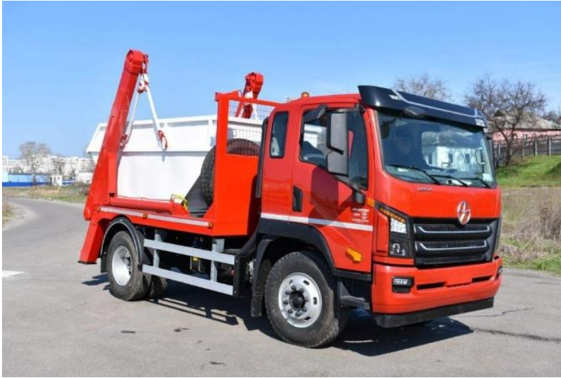
Рисунок 3.5.1 Приклад багатofункціонального сміттєвоза з системою змінних кузовів.
